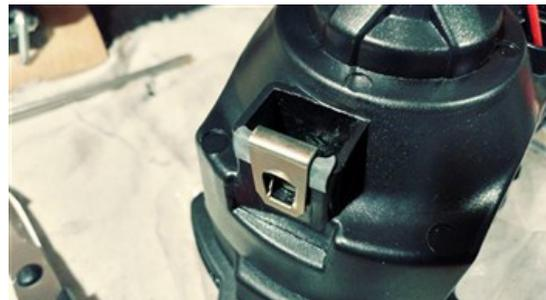
Oppure utilizzare i 2 gommini del faro analogico (comprensivi delle 2 rondelle), togliendoli appunto da questo e inserendoli nel nuovo faro.
